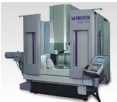
Centre d'usinage 5 axes Mikron UCP710
