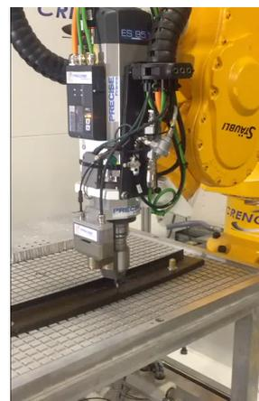
(a) Cellule robotisée hybride additive - soustractive du LURPA ; (b) électrobroche et broche orbitale
